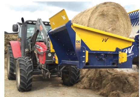
La dérouleuse accepte des balles rondes jusqu'à 800 kg.
