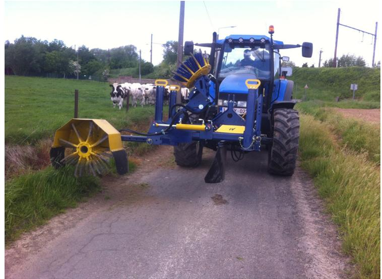
Le **déport** des brosses par rapport au centre du chargeur peut être réglé manuellement, pour s'adapter facilement à l'engin ou à la zone d'action.
