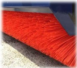
La balayeuse est composée de plusieurs balais en polypropylène d'un diamètre de 600 mm.
