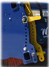
La **hauteur** de brosse est réglable manuellement sur le côté de la machine.
