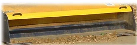
Le bac récolteur est équipé d'une lame de raclage qui permet de décrocher et récolter les gros éléments.
