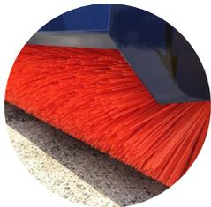
La balayeuse est composée de plusieurs **balais** en polypropylène d'un diamètre de 600 mm.
